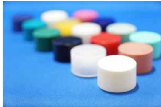
射出成形（しゃしゅつせいけい）とは、プラスチックの最も一般的な成形法のひとつです。金型とよばれる製品と同じ形の空洞（キャビティ）を持った型に熱を加えて溶かしたプラスチックを注入（＝射出）し、中で固めることで製品を作っています。
